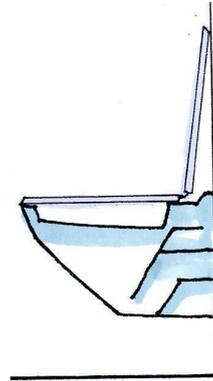
*Réservoir de chasse encastré : Utiliser les modèles conçus pour « personnes âgées » car seuls ces modèles permettent de poser la cuvette à une hauteur de 48cm.*
