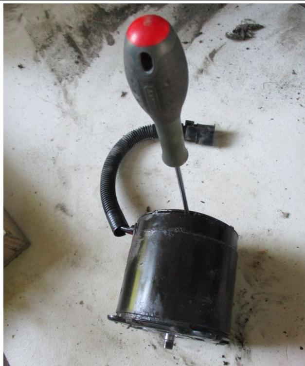
**Démontage du moteur, ouverture du couvercle**
