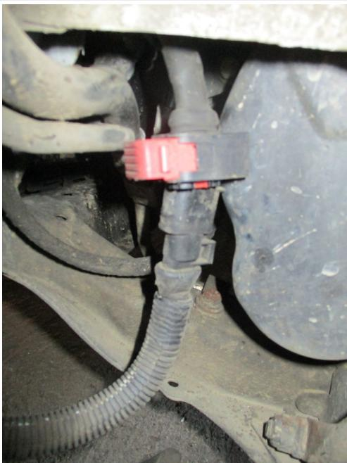
**Déconnexion du faisceau électrique du moteur-pompe**
