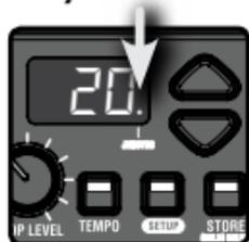
Lorsque les JamMan Solo XT sont raccordés au départ via les jacks JAMSYNC, *SYN* s'affiche dans l'affichage esclave, indiquant que la connexion JamSync est établie. L'indicateur *SYN* s'affiche également lors du premier allumage des appareils qui sont esclaves d'un maître. Les esclaves bien connectés sont également indiqués par un segment décimal qui s'allume dans l'affichage tel qu'indiqué à gauche. Si vous avez raccordé un esclave et ne voyez pas ces indicateurs, vérifiez votre câble JamSync.
