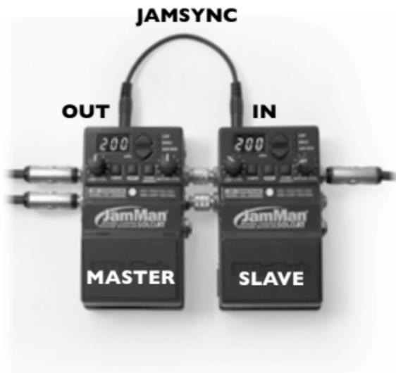
Pour utiliser JamSync, raccordez le jack du JamMan Solo XT maître **JAMSYNC OUT** au jack **JAMSYNC IN** du premier appareil esclave. Connectez en série tous les esclaves JamSync de la même façon.
